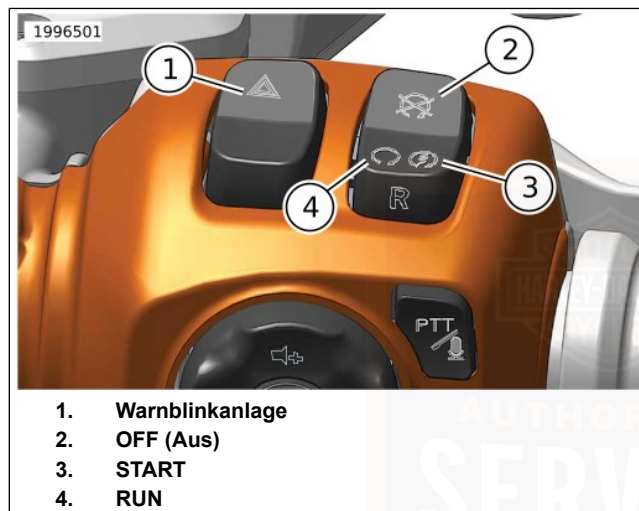
Abbildung 66. RHC-M: Tasten des Motorbetriebsschalters und der Warnblinkanlage
