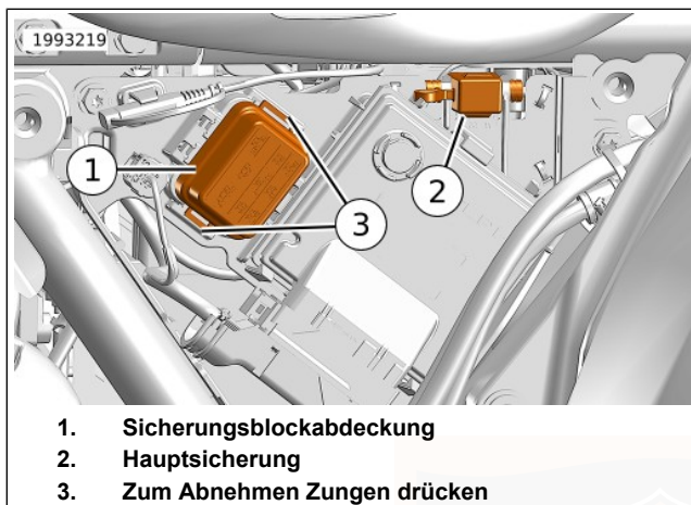
Abbildung 138. Sicherungsblock (unter der linken Seitenabdeckung)
